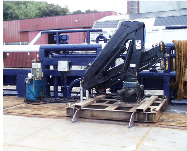
Folding crane 1,5 ton @ 8.2 mtrs
