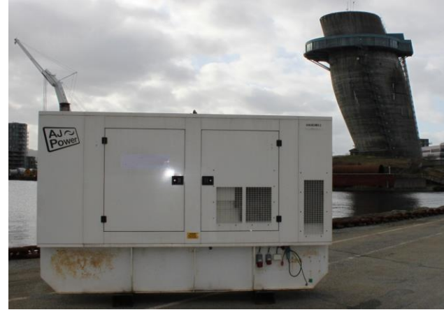
200 KVA generator 380 – 480 Volt 50/60 hz
