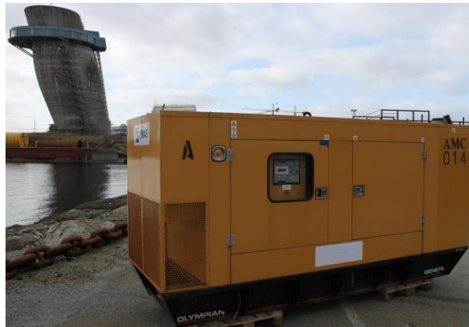
250 KVA generator 380 – 480 Volt 50/60 hz
